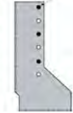
Schikking van de nagels voor ophangbeugels met naar binnen staande flenzen
