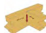
Houten stroken haaks op neerwaartse belasting
