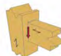
Houten stroken evenwijdig aan neerwaartse belasting
