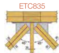
2 dubbele hoekkepers - 1 karbeel
