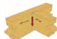
Houten stroken haaks op neerwaartse belasting
